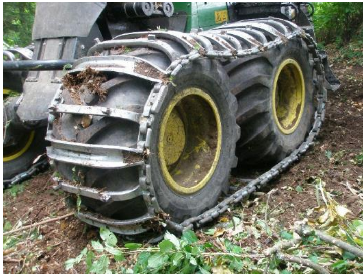
Tracks « montagne » à barrettes pour une meilleure adhérence en zone de pente
