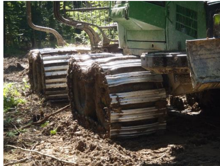
Tracks « marais » à tuiles plates et larges pour une meilleure portance sur sols sensibles au tassement
