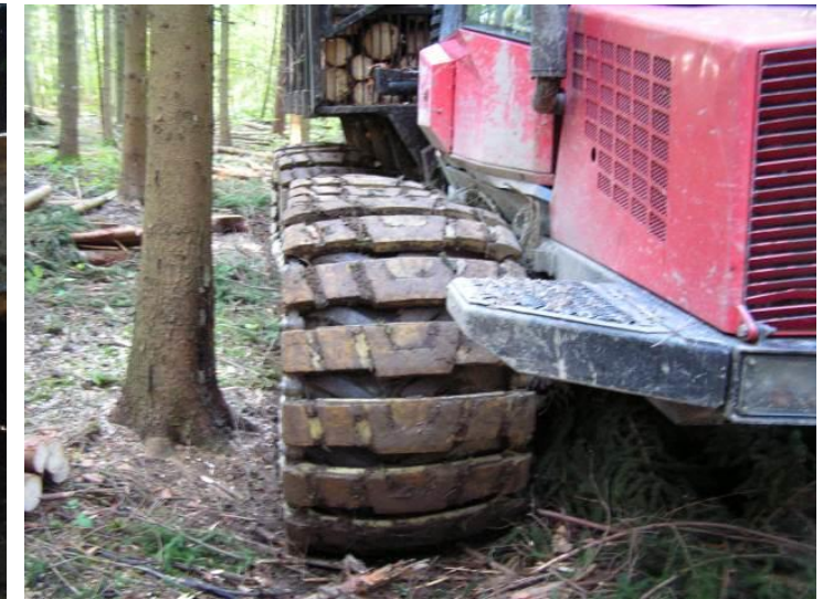
Tracks « marais » à tuiles plates et larges pour une meilleure portance sur sols sensibles au tassement
